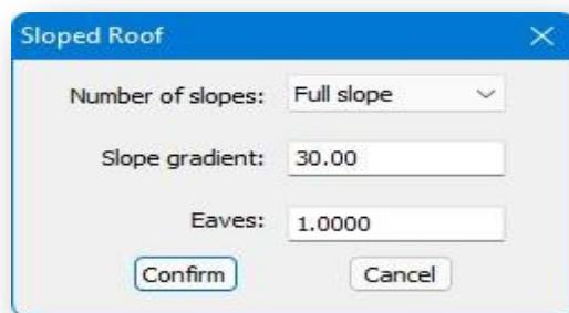
1. Înclinație completă: Generează automat un acoperiș cu pantă completă pe baza conturului acoperișului. După ce setați panta și streașina, faceți clic pe butonul "Confirm" și selectați planul superior al clădirii pentru a-l genera.
