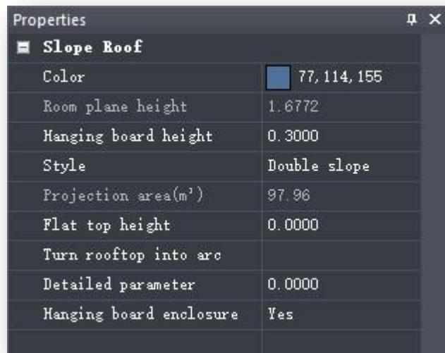
(4) Transformarea acoperișului în arc de cerc: Faceți clic pe butonul din paleta de proprietăți pentru a deschide caseta de dialog prezentată mai jos, setați parametrii arcului de cerc și apoi faceți clic pe butonul "Confirm" pentru a arci acoperișul.
